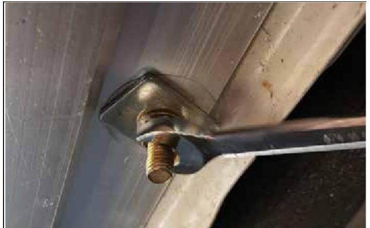
12. Unterseite: alle T-Bolzenmuttern festziehen.
