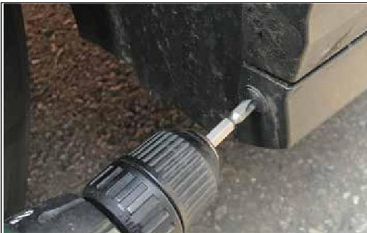
15. Die in Schritt 1 entfernte Schraube wieder in den vorderen Radkasten einbauen.
