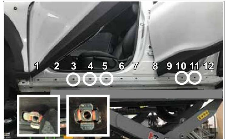
6. Seite: 5 St. beigelegte Kreuzmutter in den markierten Seitenlöcher montieren.
