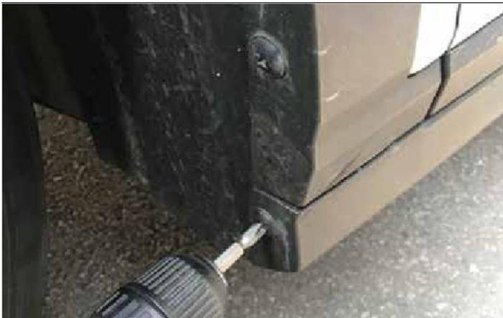
1. Die untere Schraube aus den vorderen Radkasten entfernen und zur Weiterverwendung aufbewahren.
