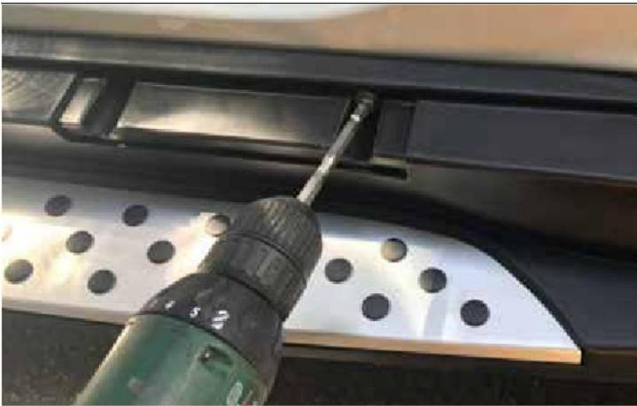
13. Seite: 5 St. beiliegende M6 Bolzen in die Kreuzmuttern montieren. Anziehen bis 5,65 Nm (57,6 kgf-cm, 4,17 lbf-ft).
