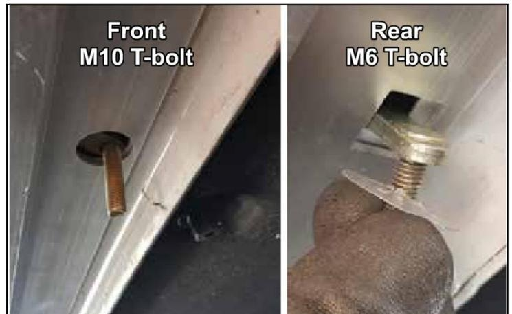
10. Unterseite vorne: der beiliegende M10 T-Bolzen + Vierkant-Unterlegscheibe + Mutter montieren.
