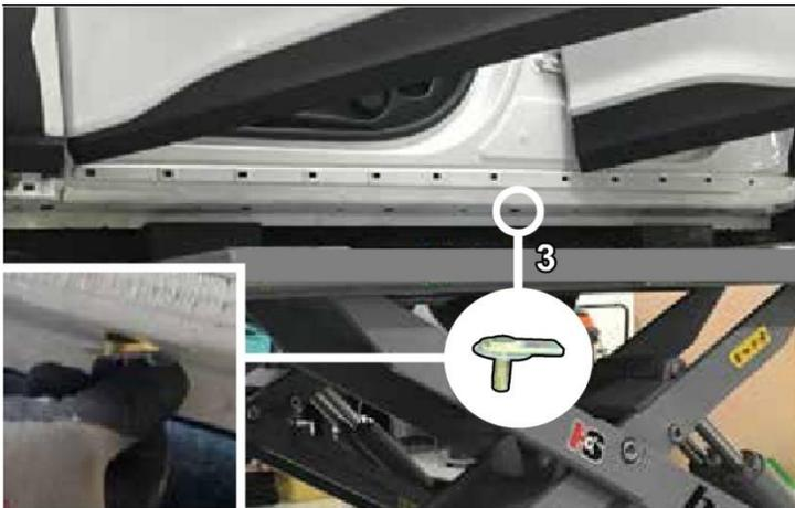
7. Unterseite: Mutter und Unterlegscheiben vom beiliegenden M8 T-Bolzen entfernen. Den T-Bolzen in das Loch Nr. 3 schieben, an der Unterseite des Fahrzeugs.
