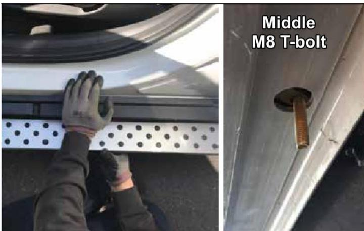
9. Das Trittbrett gegen die Unterseite des Autos anheben, so dass die M8 T-Bolzen (wie in Schritt 7 installiert) durch das mittlere Loch des Aluminium Trägers geführt wird.
