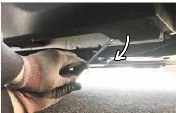
3. Die Unterseite der originalen Seitenschwellerabdeckung etwas wegziehen, um zu prüfen wo sie mit Plastikclips befestigt ist. Mit einer Kunststoff Brechstange die Seitenschwellerabdeckung von allen Befestigungspunkten vorsichtig lösen.
