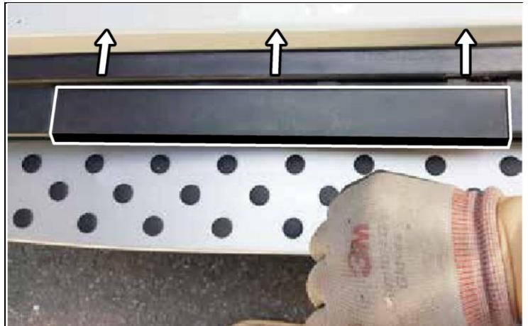
14. Die 4 beiliegenden Kunststoff Abdeckungen montieren. Bitte beachten Sie, dass die linke und rechte Versionen unterschiedlich sind.
