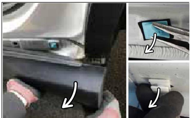
4. Die Seitenschwellerabdeckung ist jetzt nur noch seitlich fixiert mittels Plastikclips an seiner Seite angebracht. Die Seitenschwellerabdeckung entfernen durch kräftiges Ziehen. Alle zurückgebliebene Clipse entfernen. Zuerst eine Vierteldrehung drehen, dann rausziehen.
